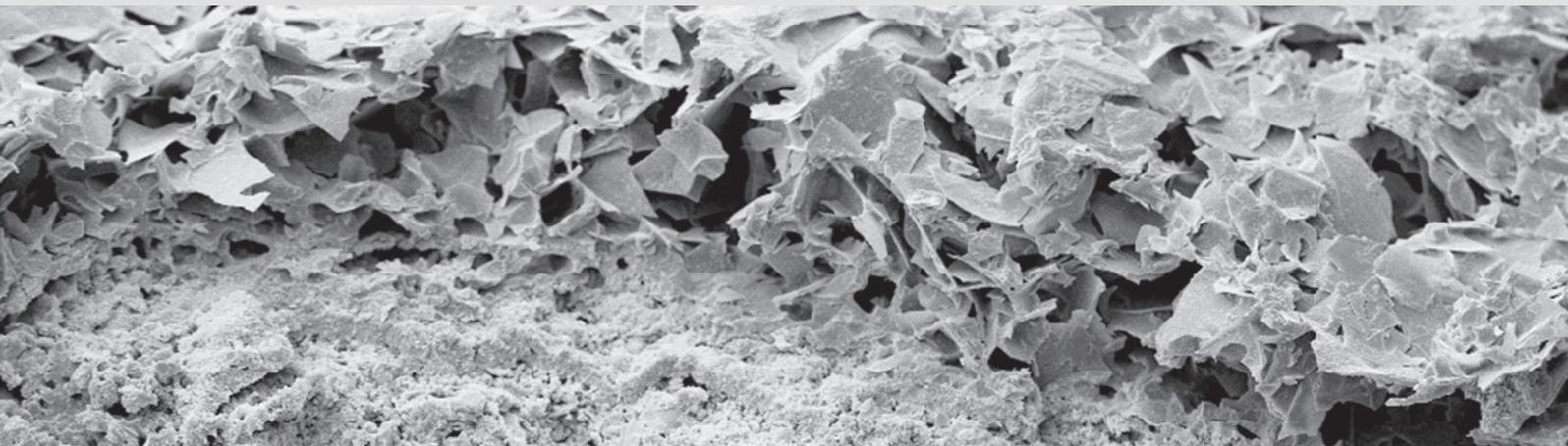
L'augmentation de surface (micropores) permet au condensat de s'évaporer
